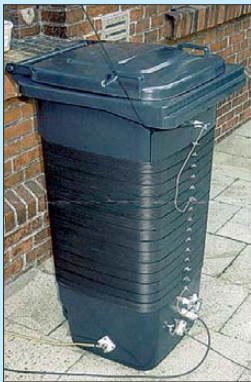
Bild 13: Eine 240-l-Mülltonne dient bei DF2BC als Wickelkörper für die Ladespule
