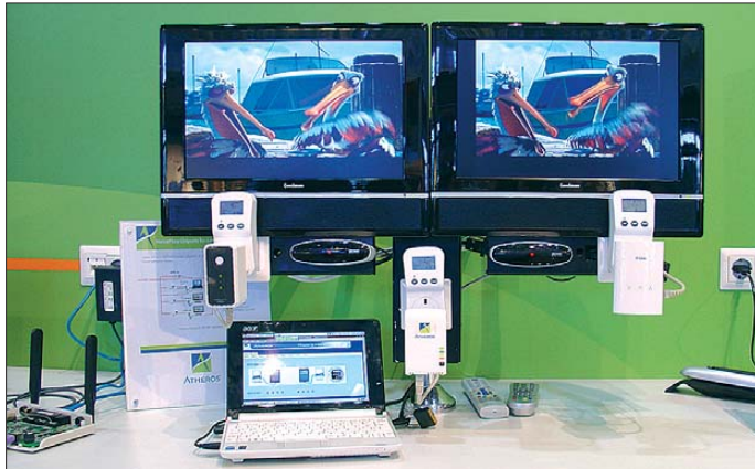
Atheros [13]: HD-Bildübertragung mit 500-MBit/s-PLC
