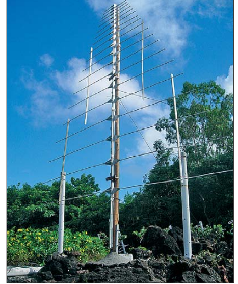
Bild 6: Logarithmisch-periodische Antenne auf einem Pfahl aus Eukalyptusholz am Astronomischen Institut MRT bei Poste de Flacq in Mauritius; die Träger und Dipole sind aus Aluminiumprofilen aus dem Baumarkt gefertigt und die seitlichen Stützen bestehen aus PE-Rohren aus dem Sanitärbereich. Der unterste Dipol dient für Messungen im 6-m-Bereich.
