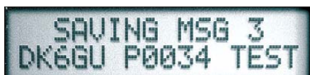
Bild 5: Ctrl-Pnnnn fügt eine Pause ein. Wählbar sind Zeitspannen zwischen 1 s (P0001) und 99 min 99 s (P9999), hier 34 s.
