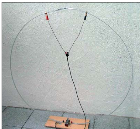
Bild 14: Anpassung der Schleifenantenne für das 80-m-Band; die Klemmen sitzen relativ dicht beieinander.
