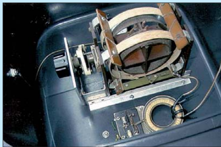
Bild 15: Innenansicht der Ladespule; hier sitzt das Variometer.
