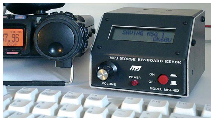
Bild 1: Tastatur und Steuerelektronik mit den Abmessungen 95 mm × 73 mm × 103 mm (B × H × T)
