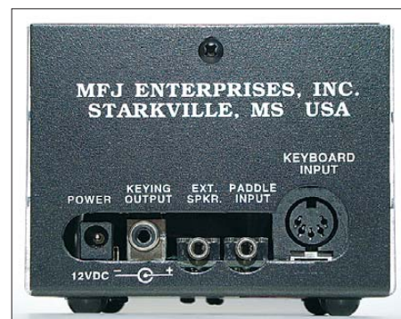
Bild 7: Auf der Rückseite befinden sich alle Buchsen, u. a. die DIN-Buchse für die Tastatur. Fotos: DF9GH
